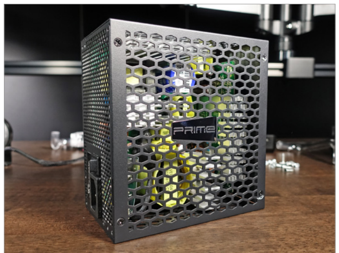
Oft ist der Netzteil-Lüfter eine große Lärmquelle. Gut, dass im Seasonic Prime Fanless PX-500 keiner davon verbaut ist. Das Netzteil ist vollständig passiv.
