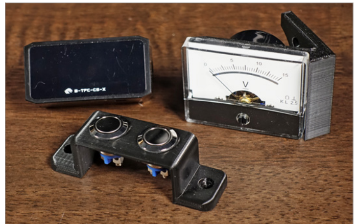
Gadgets und Basteleien: Ein selbst gebauter An-/Ausschalter mit Reset-Button, eine Temperatur- und Durchflussanzeige sowie ein Voltmeter.
