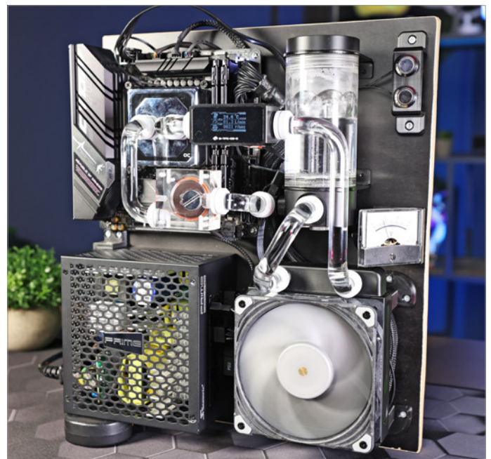
Der Rechner ist fertig und kann an der Wand befestigt werden. Dafür sollten lange Schrauben und gute Dübel genutzt werden.
