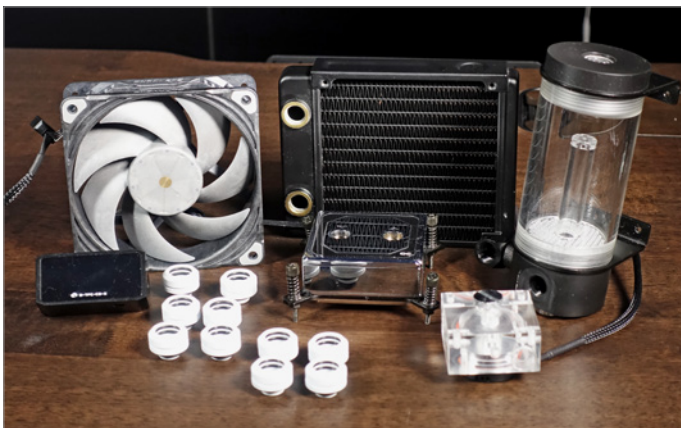
Ein paar hübsche Wasserkühlungs-Komponenten sollen im Wand-PC Platz finden, unter anderem ein 120er-Radiator sowie eine kompakte Pumpe.
