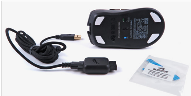
Glorious liefert die Model D 2 Wireless mit einem USB-C-auf-USB-A-Adapter aus. Damit lässt sich das Ladekabel als Verlängerung für den Nano-Empfänger nutzen.
