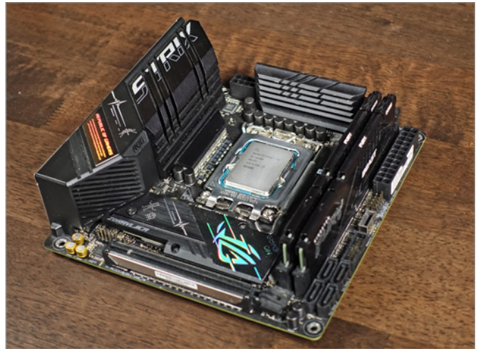
Das Asus ROG Strix B660-i Mini-ITX-Mainboard mit Sockel 1700 bietet eine gute Ausstattung bei kompaktem Format. Optimal für unseren Projekt-PC.
