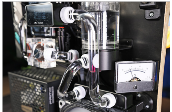
Wenn alles korrekt verbaut und angeschlossen ist, kann die Wasserkühlung befüllt und in Betrieb genommen werden.
